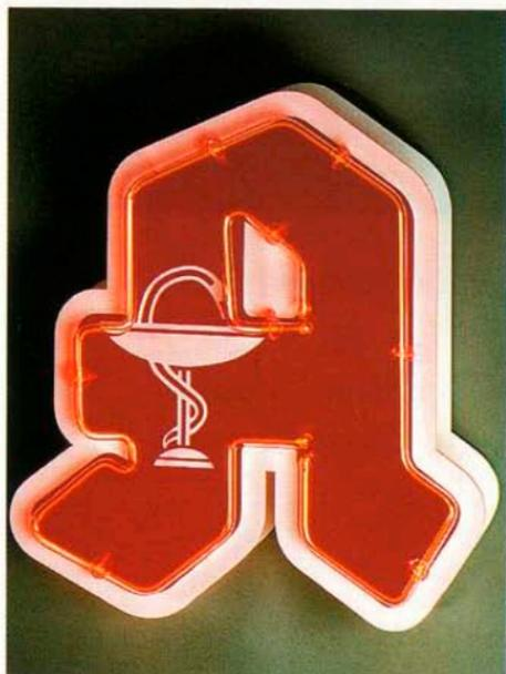
Basis für die Branchenneons bildet konturig geschnittenes und bedrucktes Acryl, auf das die Neonkonturen aufgesetzt werden. Auch eine mehrfarbige Gestaltung ist möglich.
